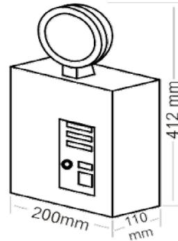
Versalite acil aydınlatma armatürü, sabit ve seyyar olarak kullanılabilir.
