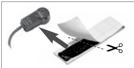
Fig. 5: Premere la massa adesiva sulla parte inferiore del pickup.
